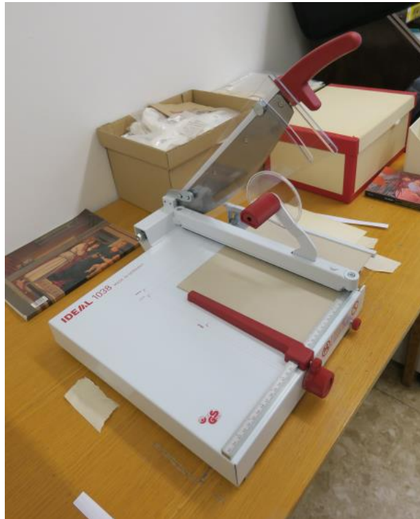
A kisebb vágógép vastagabb lemezek, kötéstáblák leszabására is alkalmas
