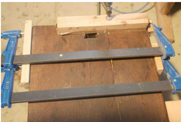
12. ábra. Az ülőrész végein keletkezett hasadásokat szorítóhatás mellett ragasztottuk meg
