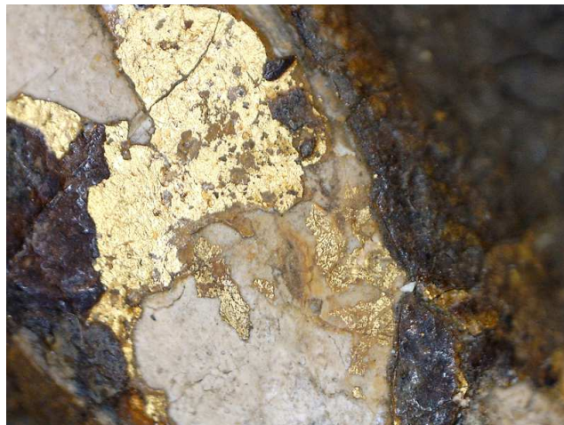
2. kép. Az USB mikroszkóppal rögzített kép - festett és aranyozott rétegek
