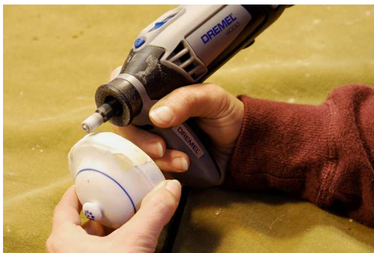
12. kép. Porcelán patikaedény fedelén a kiegészítés ívének formára csiszolása
