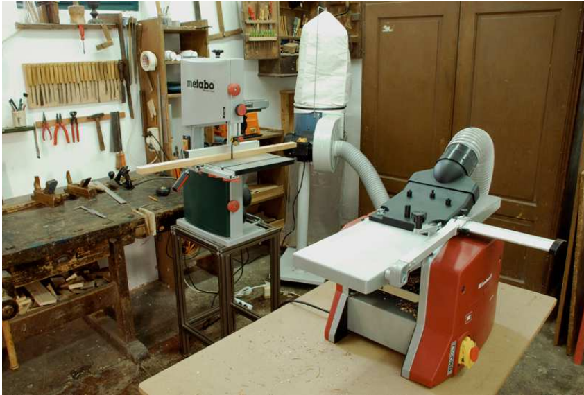
7. kép. Szalagfűrész, forgácselszívó és vastagoló gyalugép
