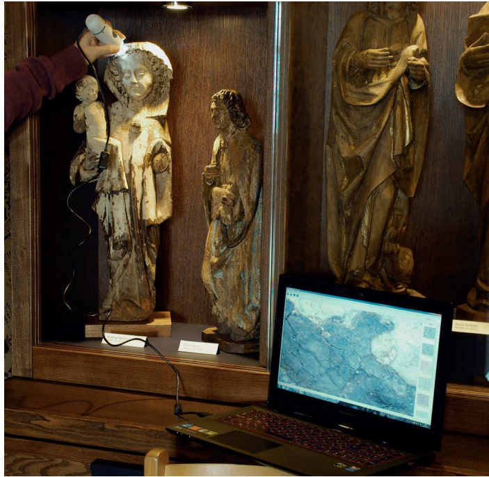
1. kép. Festékrétegek vizsgálata USB mikroszkóppal
