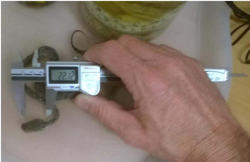
2. kép. Digitális tolómérő zoológiai preparátumok tudományos precizitású méréséhez.
